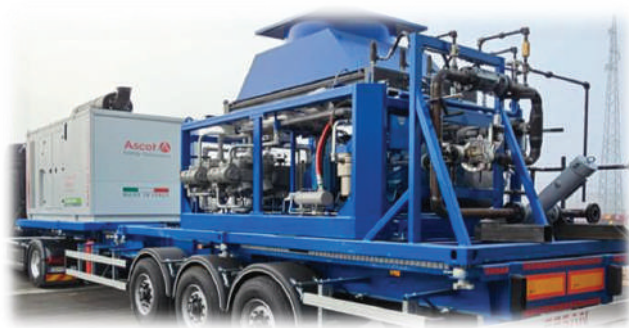
Slika 13. Postrojenje za prepumpavanje plina Izvor: Plinacro
